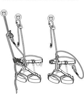
Рис. 8. Применение усов самостраховки
