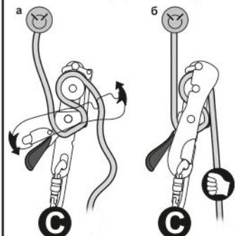
Рис. 4. Установка устройства на анкерную точку
