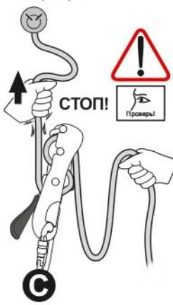
Рис. 10б. Проверка на анкерной точке
