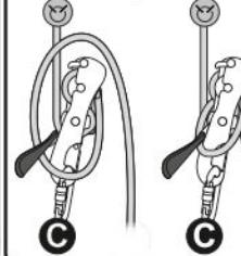
Рис. 9б. Блокировка при длительной остановке
