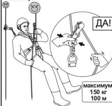
Рис. 6. Функционирование устройства
