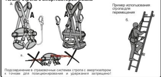
Рис. 6. Использование карабинов, входящих в состав стропов
