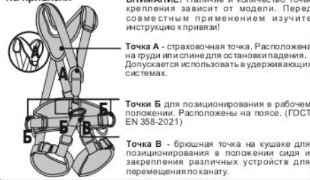
Рис. 5. Способы крепления к анкерным устройствам
