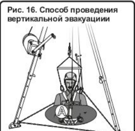
Рис. 16. Способ проведения вертикальной эвакуации
